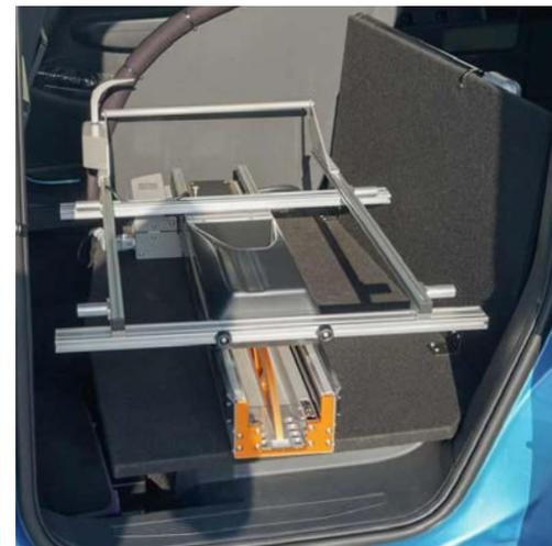
**Ladeboy S2 Maximum** zur Verladung eines starren Aktivrollstuhls. Die Maximale Traglast liegt bei 38 kg.
